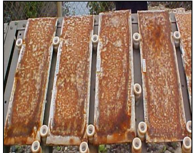
Fig 19. Probetas galvanizadas, un (1) año de Exposición, estación Rompeolas
