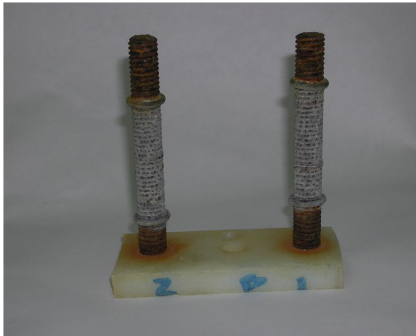
Fig. 11 Probetas “alambre sobre tornillo” de la Estación Rompeolas al mes de exposición.
