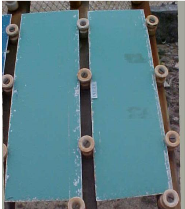
Figura 21. Probetas prepintadas (verde –blanco), 12 meses de exposición, estación Rompeolas
