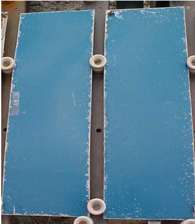
Figura 20. Probetas prepintadas (azul-blanco), 12 meses de exposición, estación Rompeolas
