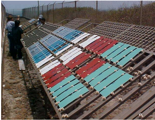
Fig .15 Colocación de probetas en el Rompeolas
