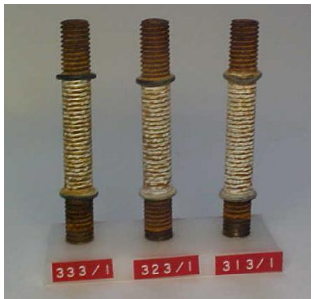
Fig. 14 Probetas de alambre sobre tornillo, segundo trimestre de exposición, estación Tierra Adentro
