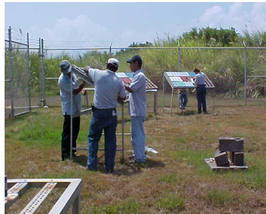
Fig .16 Colocación de probetas en la estación Costera
