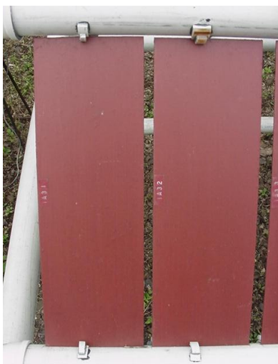
Fig 26. Probetas después de 6 meses de exposición ,Estación Urbana
