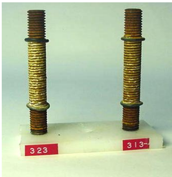
Fig. 13 Probetas "alambre sobre tornillo" primer trimestre de exposición, estación Tierra Adentro
