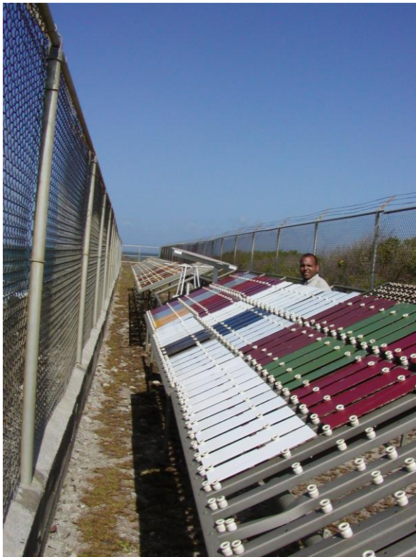
-Fig 23. Bastidores con las probetas bajo ensayo
