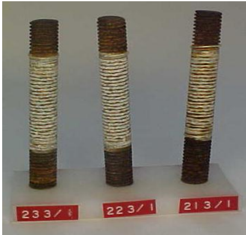
Fig. 12 Probetas "alambre sobre tornillo" segundo trimestre de exposición, Estación Costera
