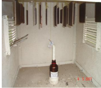
Vista del Interior de una Cámara Indoor: probetas, botella de captación de cloruro ambiental y captadores de dióxido de azufre ambiental e Higrotermógrafo
