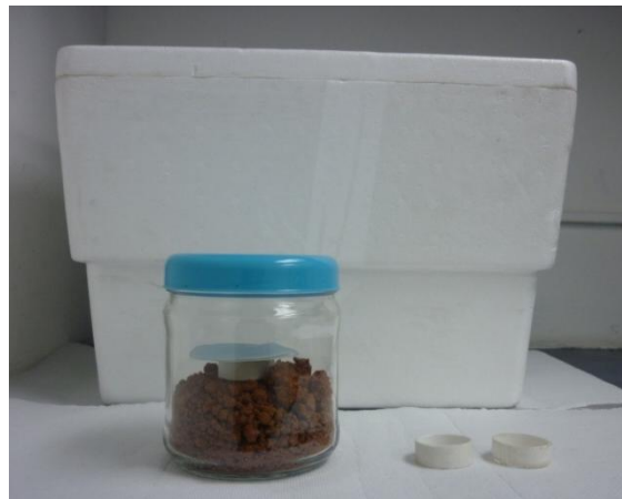
Figura 10. Envase hermético donde se realiza el equilibrio de la presiones de vapor de agua, a la derecha los anillos inertes que sostienen el papel filtro.
