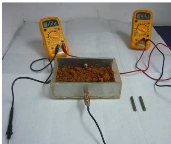
Figura 11. Caja de material inerte con las medidas estipuladas en el método, a la derecha los electrodos utilizados para la confección del circuito.
