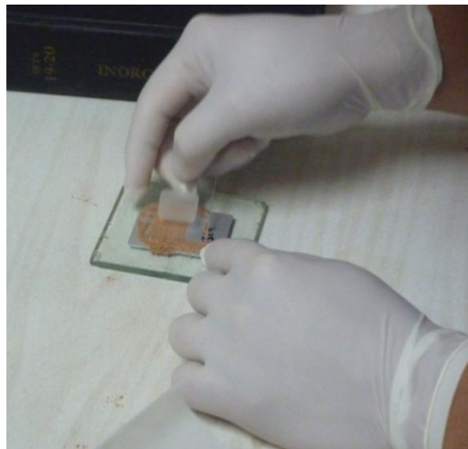
Figura 13. Confección de la placa de mineral arcilloso introducida en el difractómetro.
