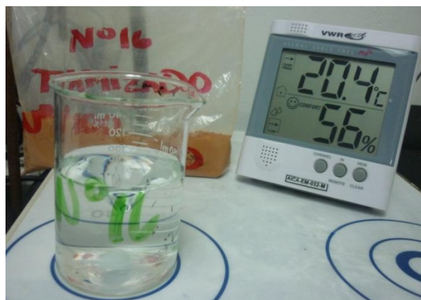
Figura 6. Agitación automatizada de la alícuota de de la suspensión de suelo extraída antes de introducirla al espectrofotómetro.
